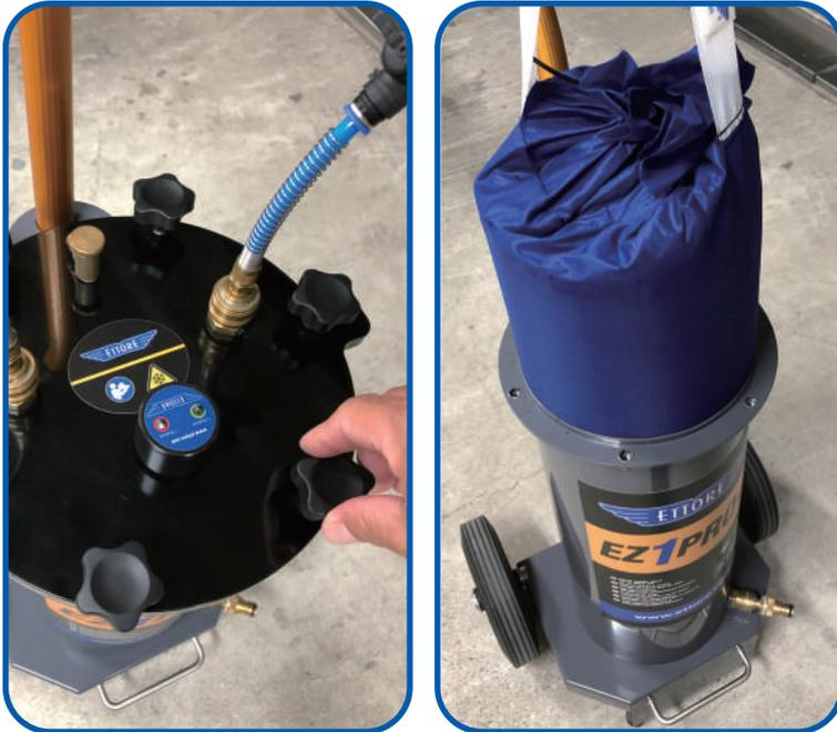
本体上部のネジを回し蓋を外し、中にあるレジンバッグを取り出して交換するだけ！
